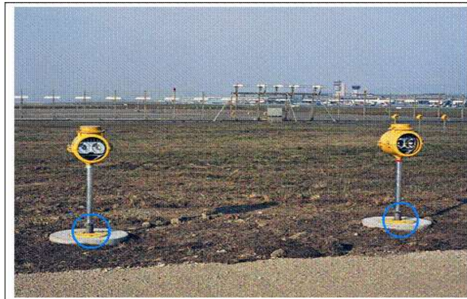
Figura ADJB-6. Ejemplos de Cuplas Frangibles montaje de tubos en luces de aproximación
