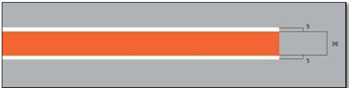
Figura 2-5-1. Línea de seguridad en plataforma ABL
