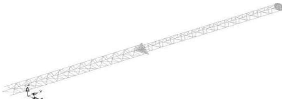
Torre de iluminación de aproximación — estructura reticular de aluminio
