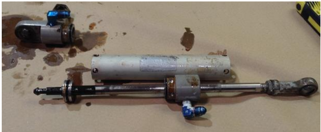
Fotografía 8. Desarme del cilindro actuador del tren principal izquierdo.
