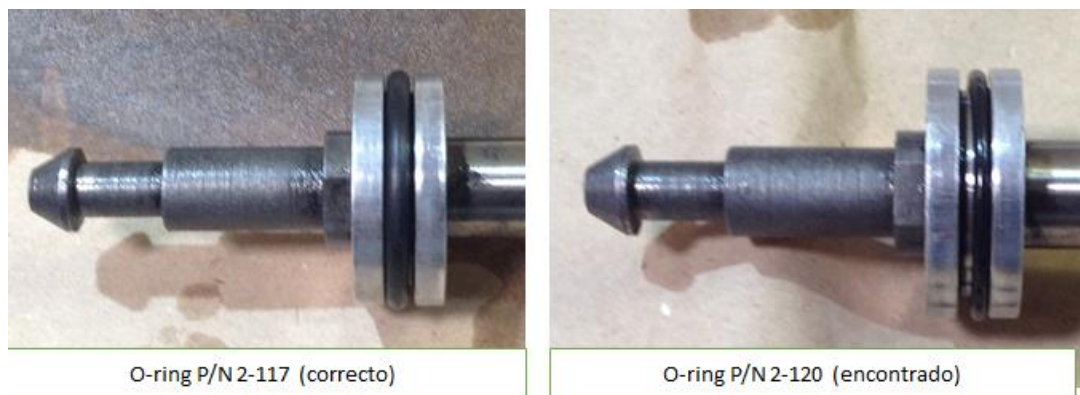
Fotografía 9. Comparación entre O-ring correcto y el encontrado en el pistón del cilindro actuador del tren principal izquierdo.
