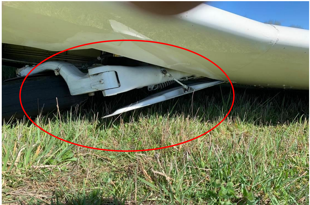
Fotografía 2: Tren principal izquierdo colapsado, a medio recorrido
