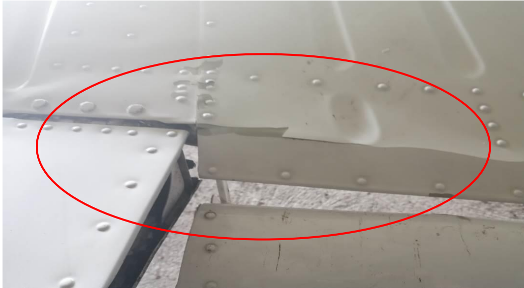
Fotografía 4: Zona de flap izquierdo con daños.
