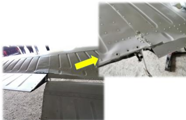
Fotografía 6. Vista del ala izquierda, daños en la zona del fitting exterior de flap.
