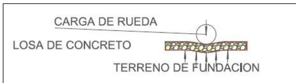
Figura 1-3-1. Transferencia de carga de una rueda en una estructura de pavimento rígido
