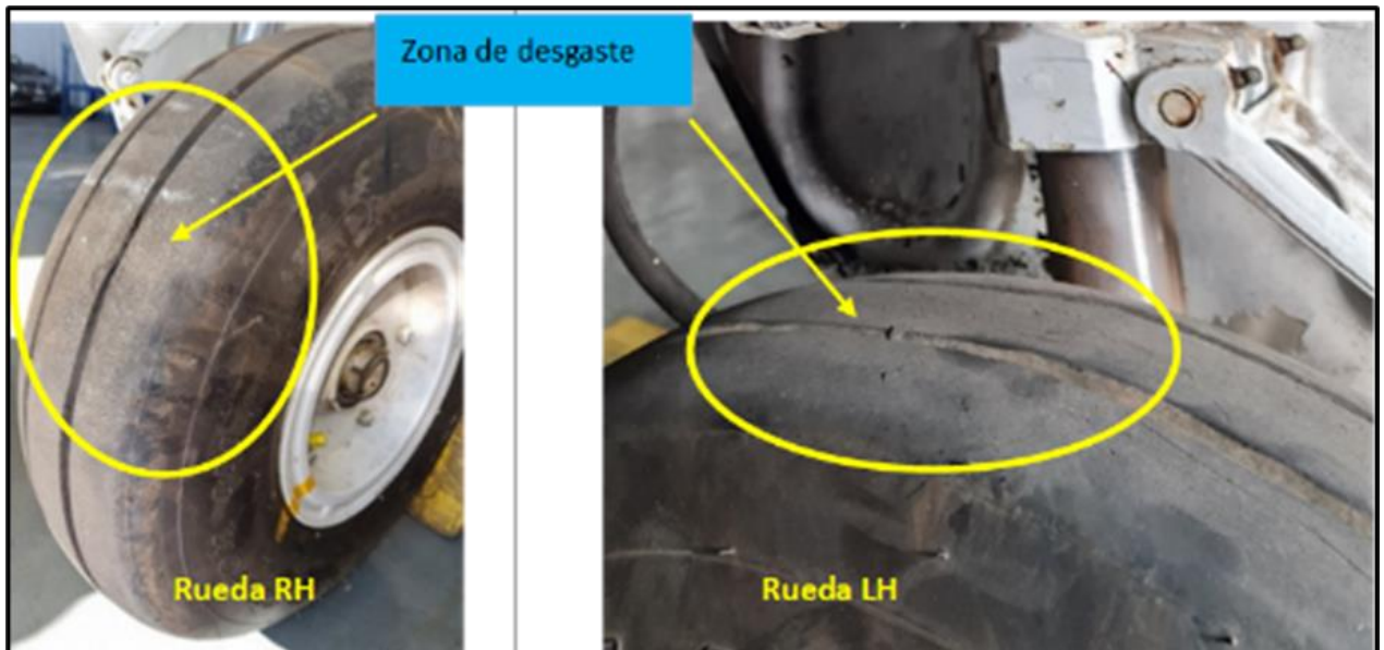
Imágenes N°6 y 7: Neumático derecho e izquierdo con evidencia de desgaste en un punto aislado.
