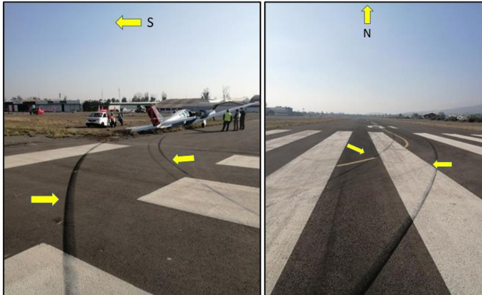
Imágenes N°3 y 4: Marcas de neumáticos dejadas por la aeronave.
