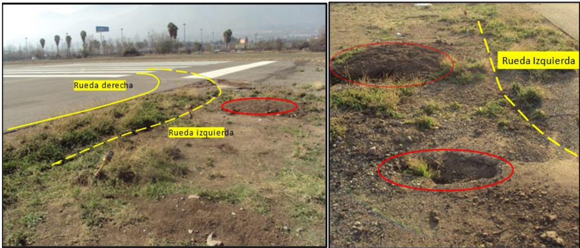
Imágenes 5 y 6: Marcas dejadas por la aeronave fuera de la calle de rodaje Delta.
