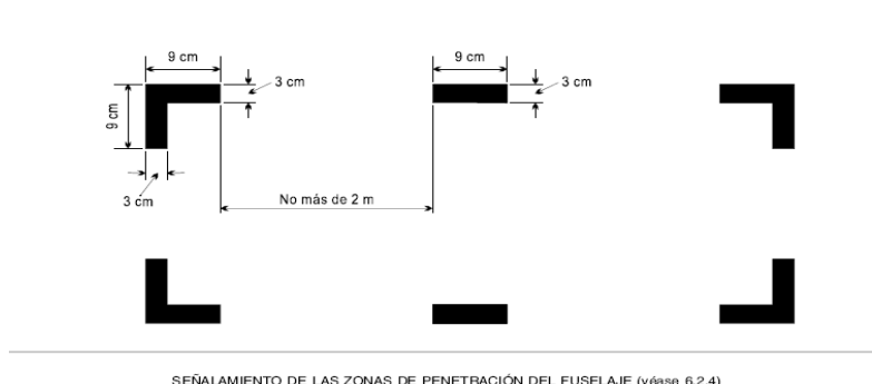
SEÑALAMIENTO DE LAS ZONAS DE PENETRACIÓN DEL FUSELAJE (véase 6.2.4)
