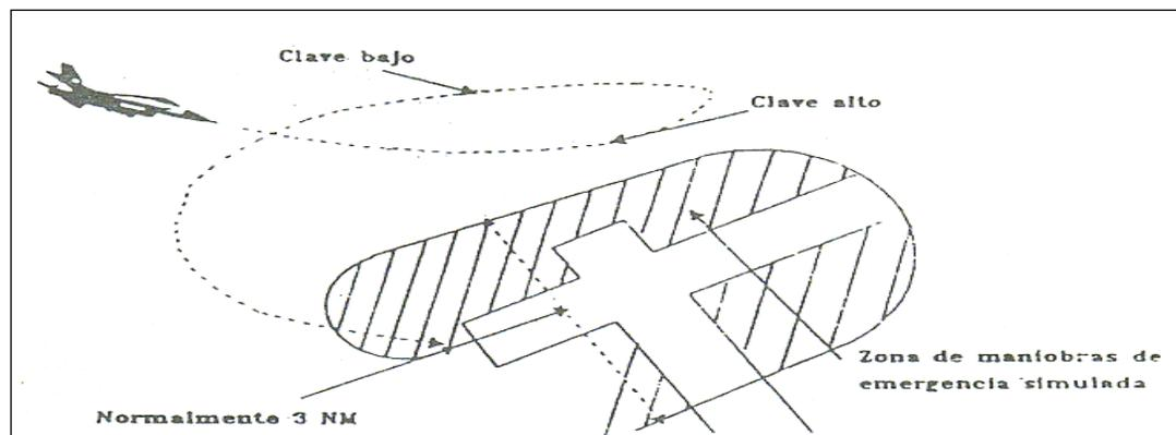
La zona de maniobras de emergencia simulada es el espacio aéreo para ser ocupado por una aeronave practicando procedimientos de emergencia simulado, que comienza en clave alto, incluye clave bajo y termina en el umbral de aterrizaje.
