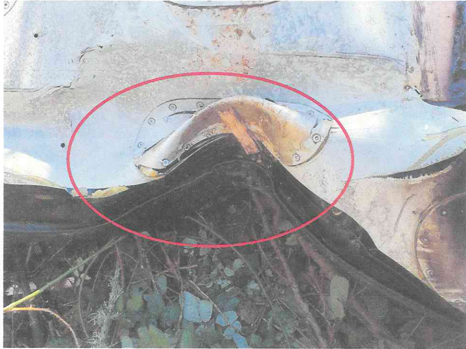
Fotografía 4: Impacto de árbol en la zona del borde de ataque
