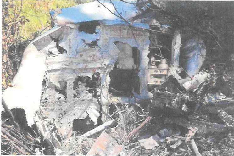
Fotografía 6: Zona de cabina e instrumentos destruida.
