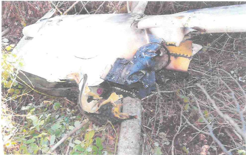
Fotografía 3: Punta de ala derecha y alerón desprendida.
