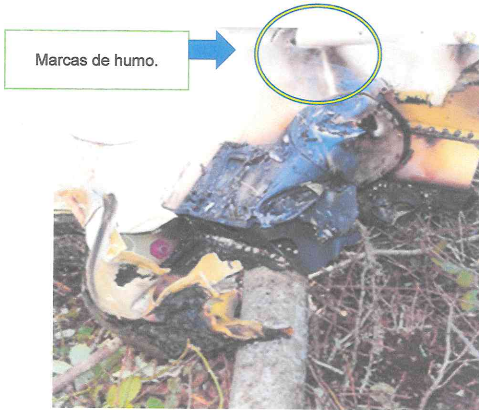
Fotografía N° 5. Vista de zona de corte del ala derecha, con quemaduras.
