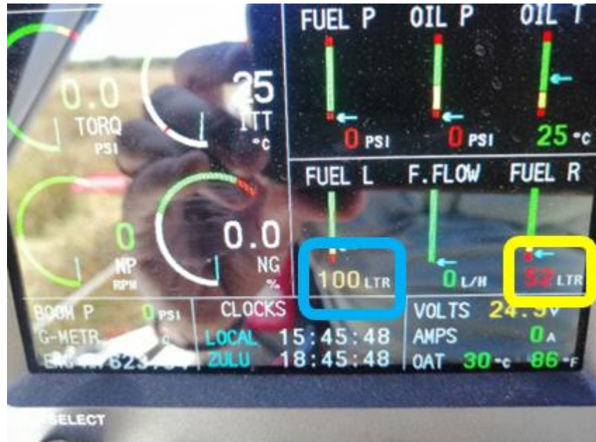
Fotografía N° 8: Vista de la indicación de combustible.
