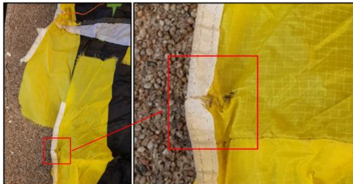
Imágenes N°10 y 11: Daños en el borde de fuga de la vela y lugar de inicio de la rasgadura.
