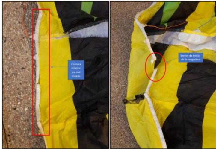
Imágenes N°10 y 11: Daños en el borde de fuga de la vela y lugar de inicio de la rasgadura.
