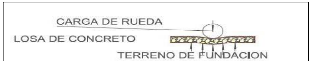
Figura 1-3-1. Transferencia de carga de una rueda en una estructura de pavimento rígido
