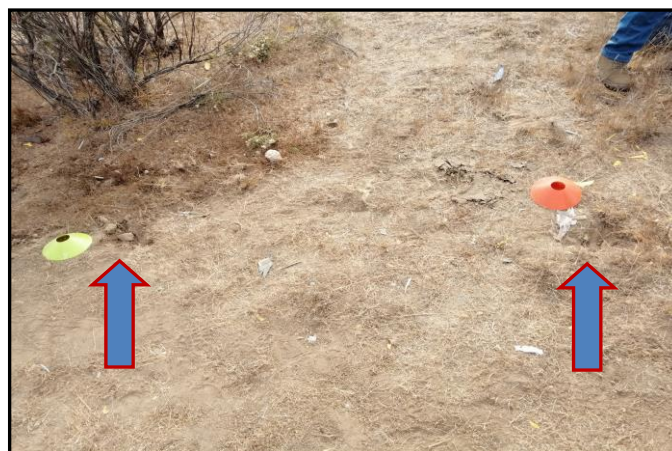
Fotografía N° 6: Huellas del contacto de las palas del rotor de cola en el terreno.
