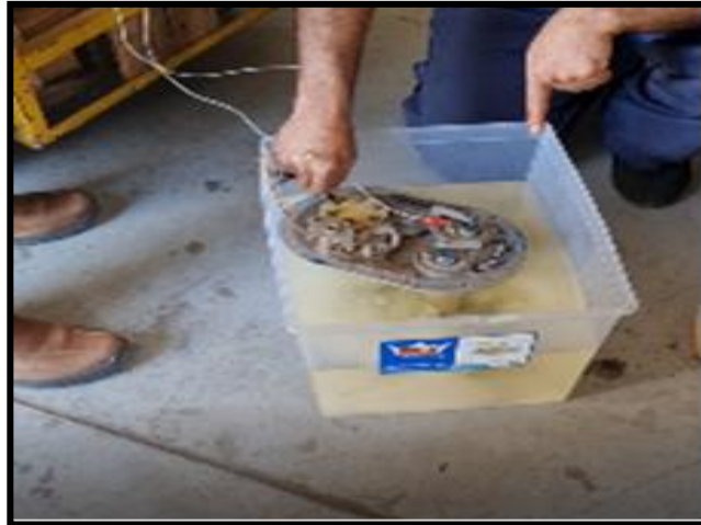
Fotografía 09: Prueba de las bombas de combustible
