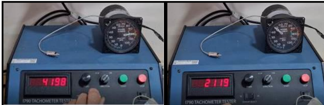
Fotografía 11: Indicador dual de revoluciones del rotor y del motor
