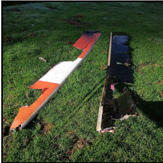
Fotografía 07: Pala del rotor principal dañada por volcamiento y apoyo en árboles, sin daños en los bordes de ataque.
