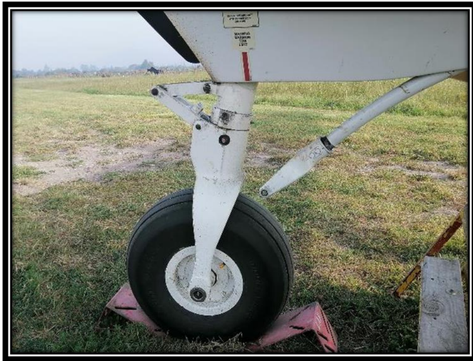
Fotografía N° 2: Horquilla del tren de nariz desconectada.
