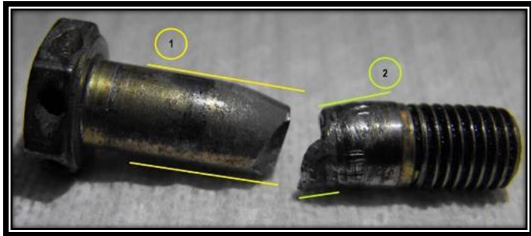
Fotografía N°5: Perno fracturado por estiramiento o tracción.
