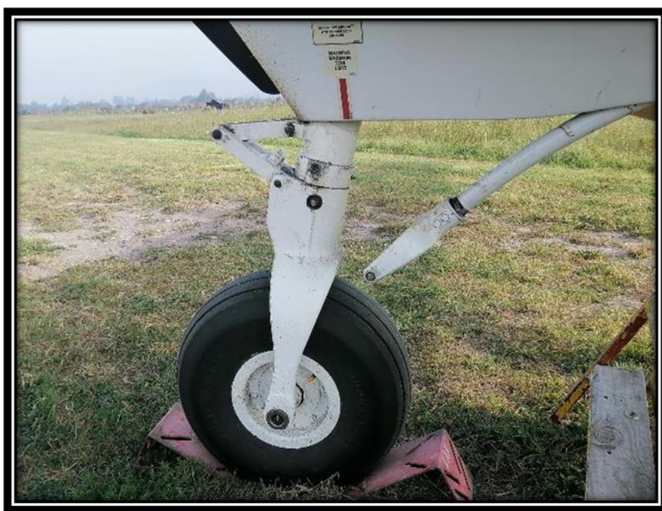
Fotografía N° 2: Horquilla del tren de nariz desconectada.
