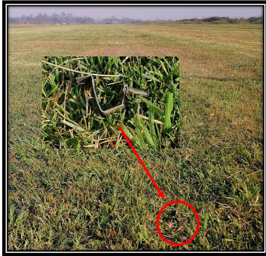
Fotografía N° 1: Perno lado izquierdo desprendido en la pista
