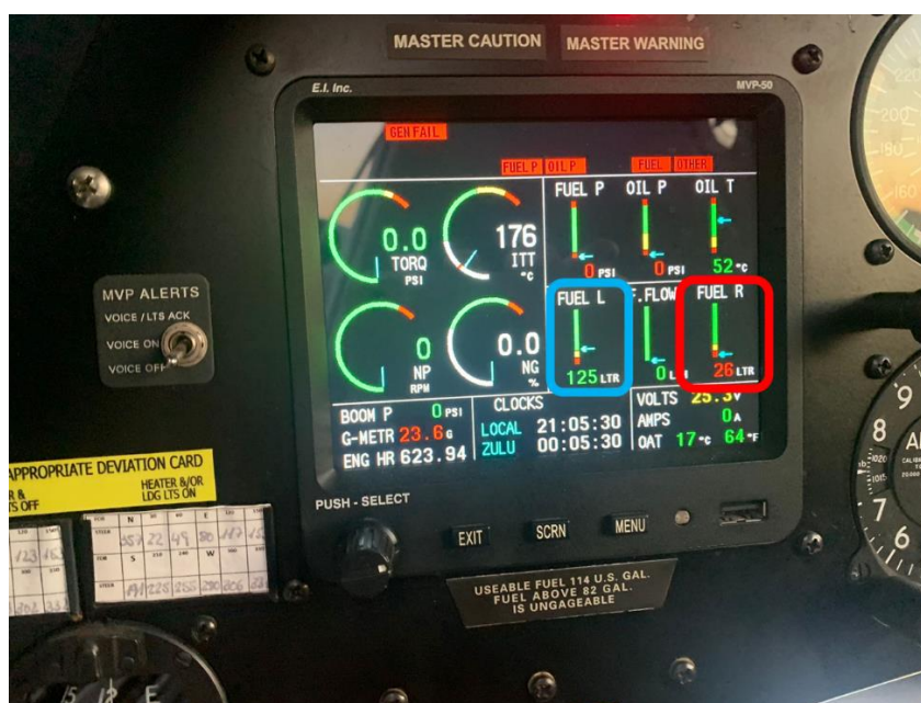
Fotografía N° 7: Vista de la indicación de los estanques de combustible, izquierdo (cuadro celeste) y derecho (cuadro rojo), de la aeronave, aproximadamente, 01:15 horas después del suceso.
