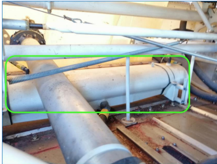
Fotografía N° 9: Vista del Header Tank (cuadro verde), y sus líneas de abastecimiento de combustible.
