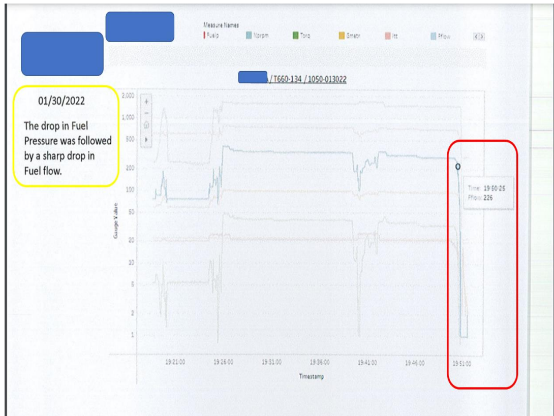
Imagen N° 3: Registro de la caída del caudal de combustible y la hora local.
