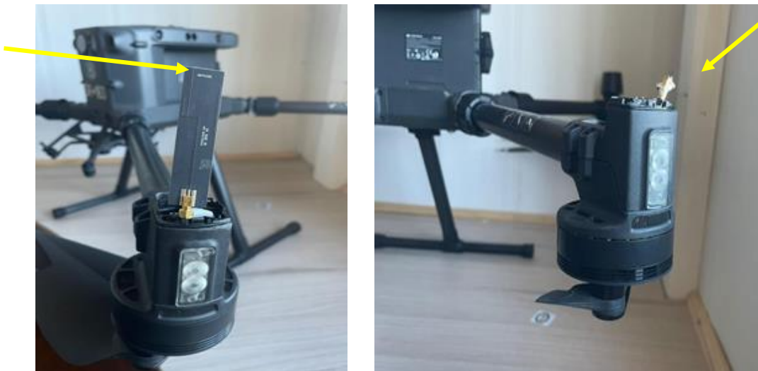
Fotografías N° 6 y 7: Vistas de las antenas dañadas.
