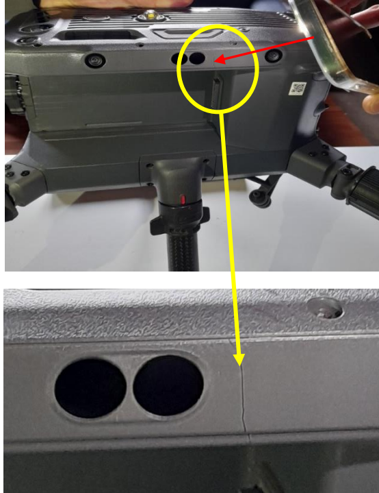
Fotografías N° 8 y 9: Vista de la fractura de la carcasa lado derecho.
