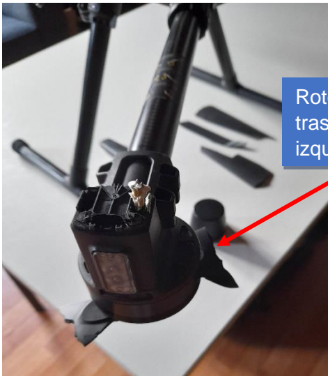
Fotografías N° 3 y 4: Rotores delantero y trasero del lado izquierdo dañados.
