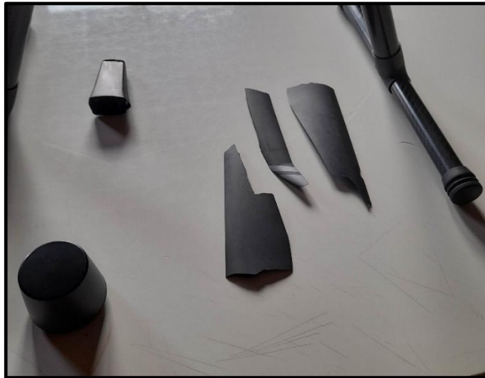
Fotografía N° 5: Vista de los trozos de rotores y carenas dañadas.
