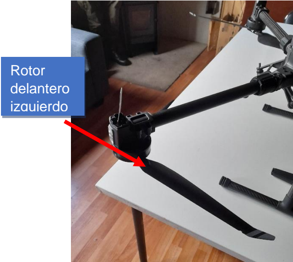
Fotografías N° 3 y 4: Rotores delantero y trasero del lado izquierdo dañados.
