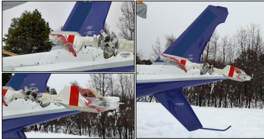
Imágenes N°8, 9 y 10: Daños en las palas rotor de cola
