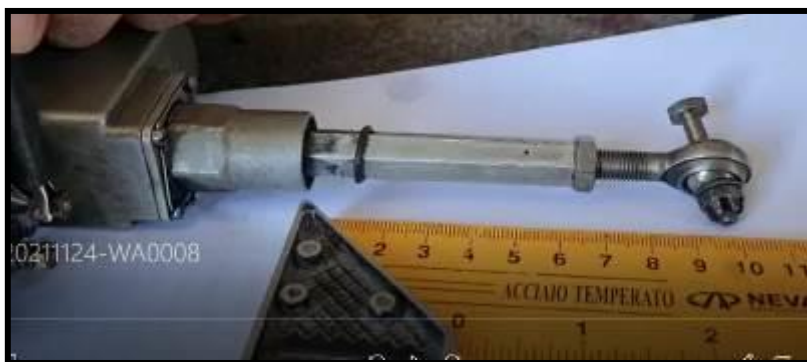
Fotografía 10: Eje compensador de caída de revoluciones de motor
