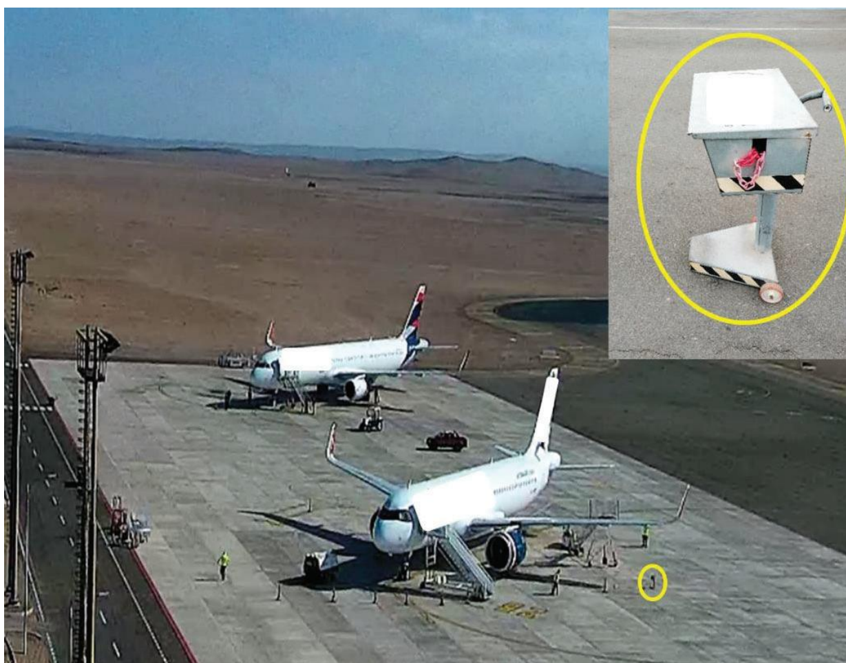
Imagen N° 8: Ubicación del PIGS (Passenger Integrated Guidance System) debajo, y más al interior, del ala izquierda de la aeronave.
