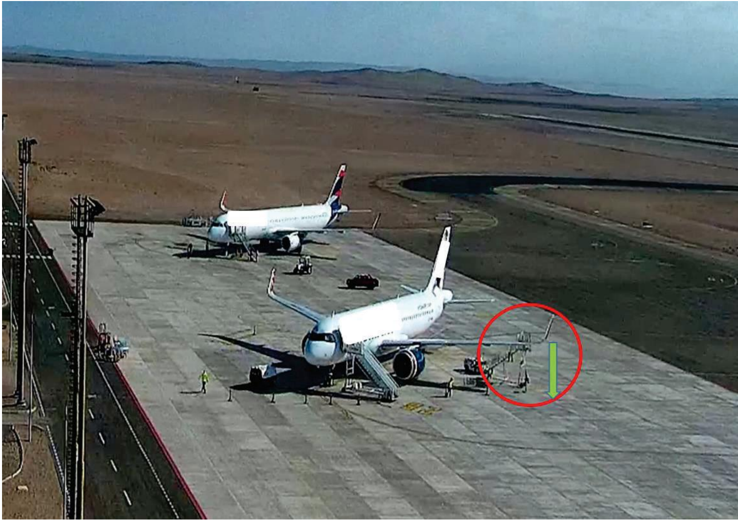
Imagen N° 6: Impacto de la parte superior de la escalera contra la punta de ala izquierda.
