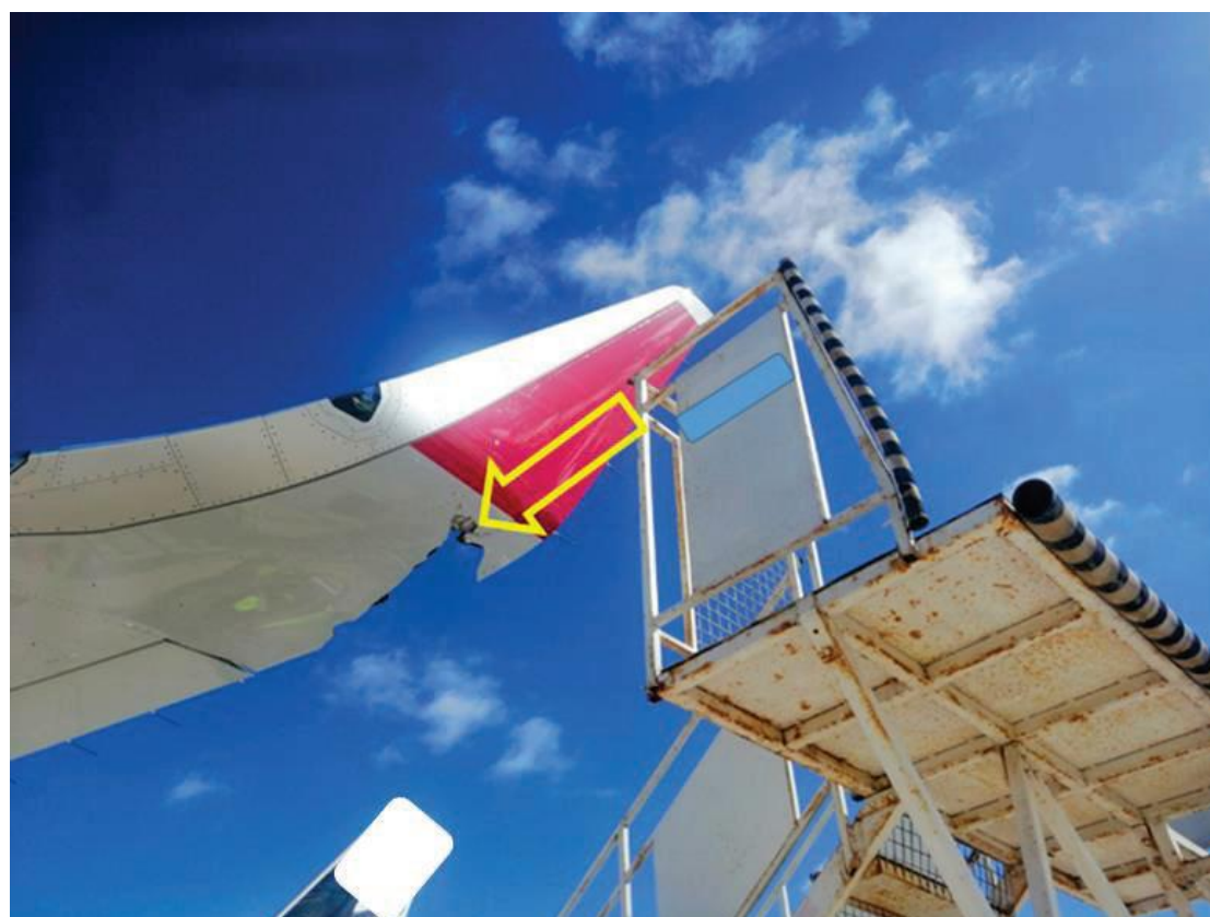
Fotografía N° 8: Vista de la dirección de aproximación de la escalera, contra la punta de ala izquierda.
