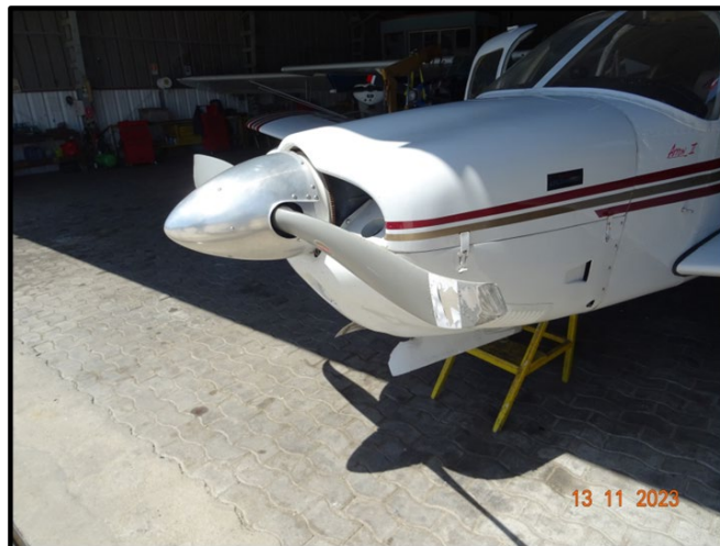
Imagen N°4: Daños en las palas de la hélice
