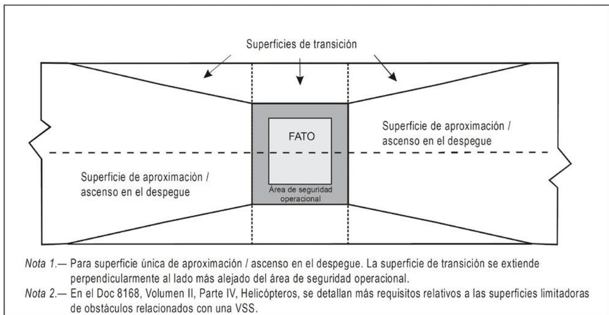
Figura A-2-5. Superficies de transición de la FATO para operaciones por instrumentos con aproximaciones que no son de precisión o de precisión
