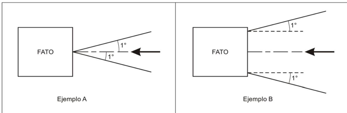
Figura A-5-16. Divergencia del sector “derrota correcta”
