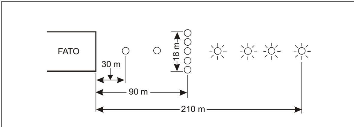
Figura A-5-15. Sistema de luces de aproximación
