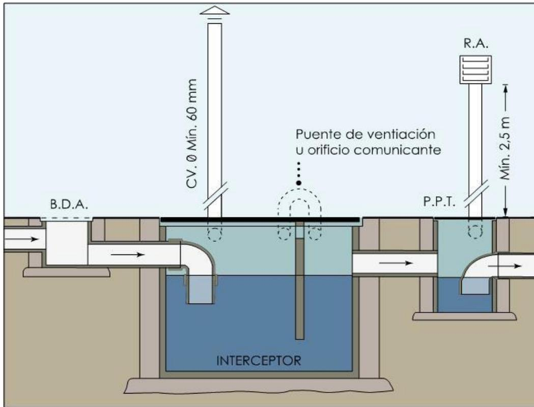
Figura A-3-7. Interceptor de combustible típico
