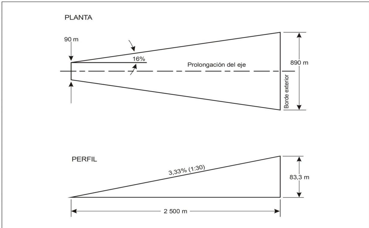
Figura A-2-4. Superficie de aproximación de la FATO para aproximaciones que no son de precisión
