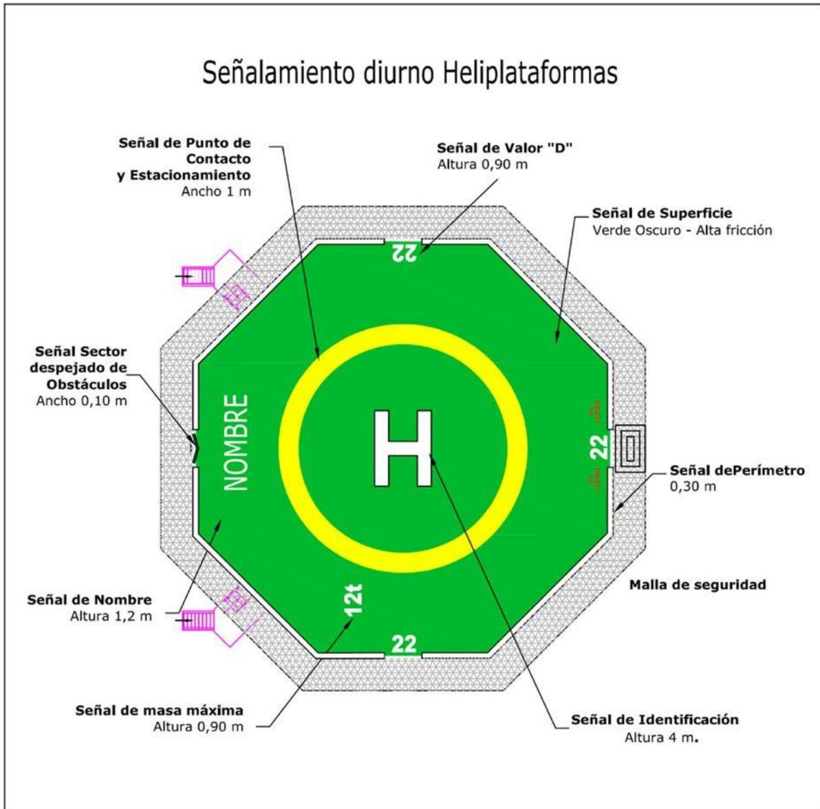
Figura A-5-8. Señalamiento de heliplataforma
