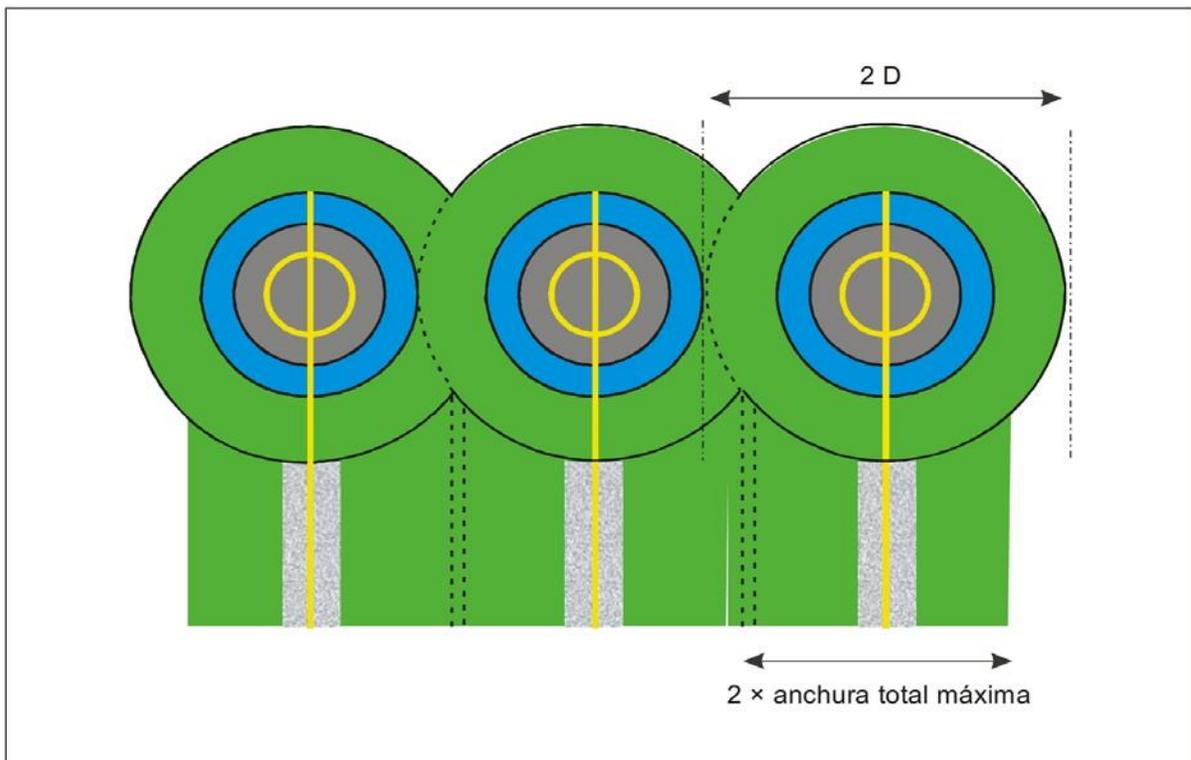
Figura A-3-6. Puestos de estacionamiento de helicópteros diseñados para virajes estacionarios en rutas / calles de rodaje aéreo – operaciones no simultáneas
