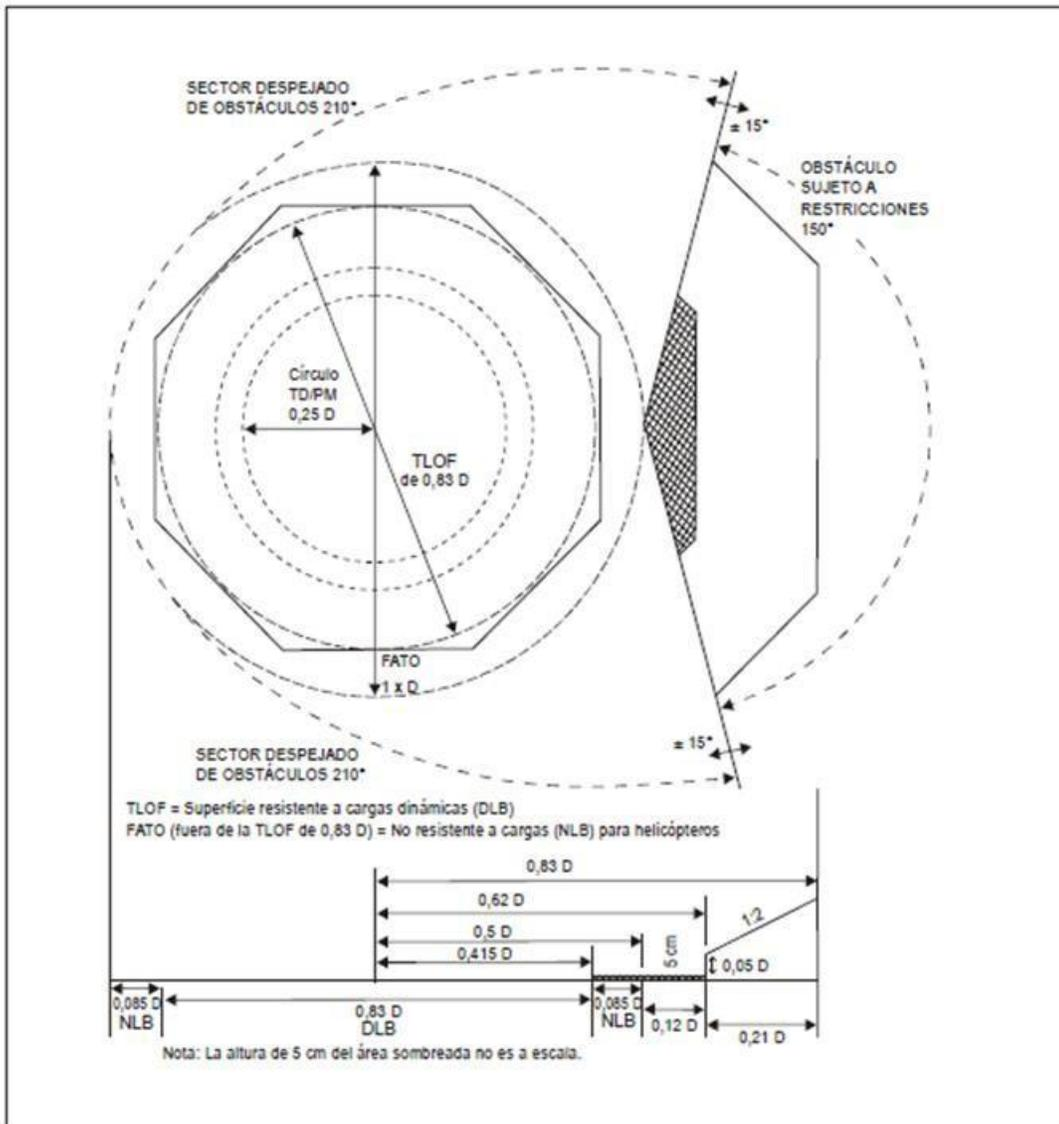
Figura A-4-9. Sectores y superficies limitadoras de obstáculos en heliplataformas para una FATO para una FATO y una TLOF de 0,83 D y mayor.
