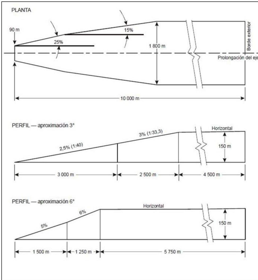
Figura A-2-3. Superficie de aproximación de la FATO para aproximaciones de precisión.
