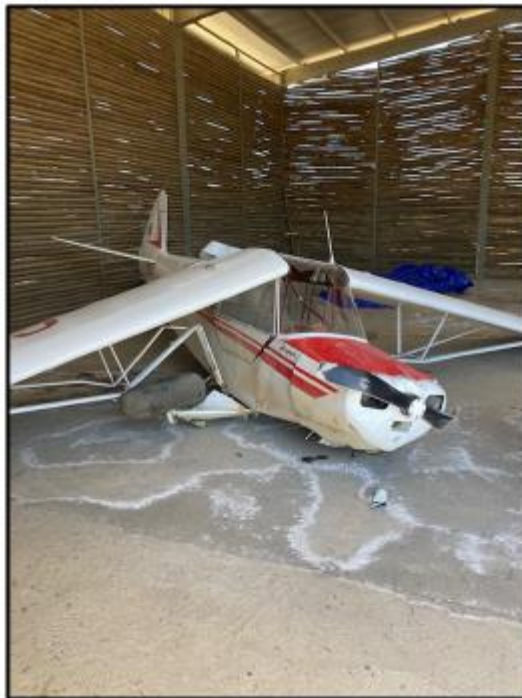
Imagen N°4: Daños en las palas de la hélice
