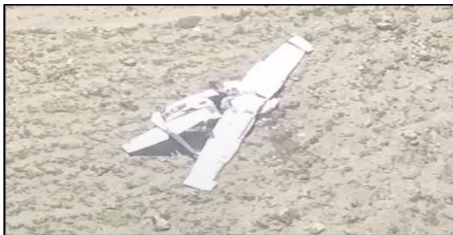
Fotografía N°24. Patrón de restos de la aeronave investigada, en Barrena o Spin.
