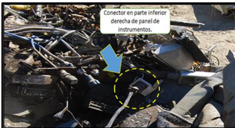
Fotografía N°22. Vista de conector y cable de alimentación eléctrica para la cámara aerotransportada marca Leica ALS60.
