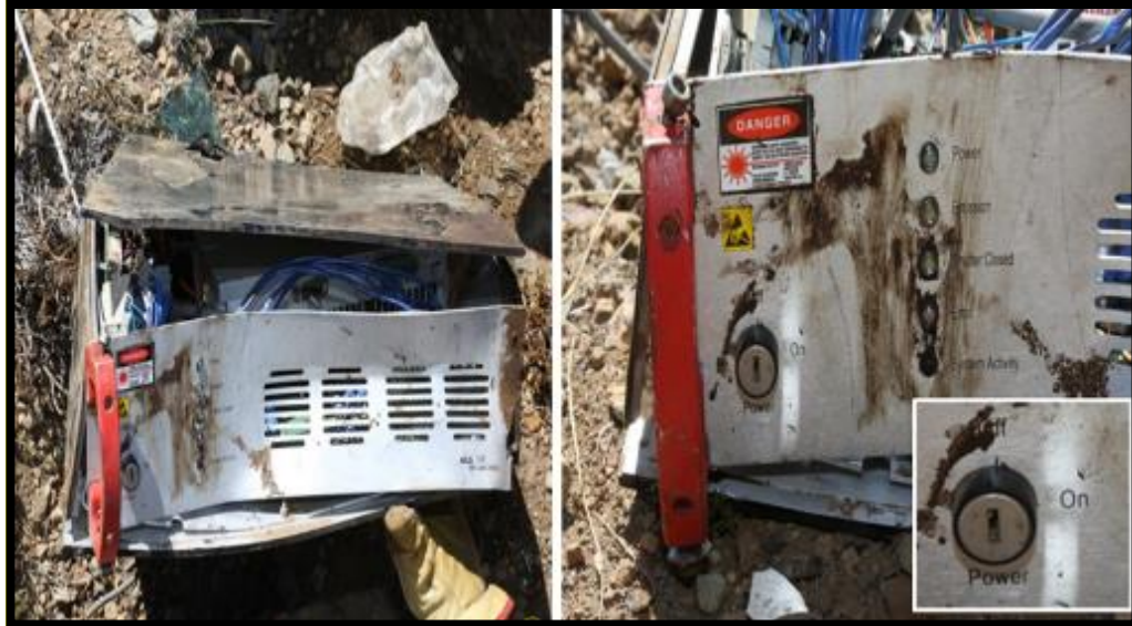
Fotografía N°13. Módulo controlador láser LC60 con su interruptor en la posición OFF.
