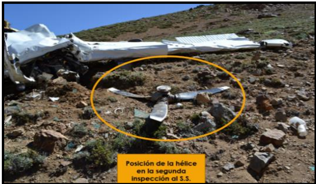
Fotografía N°18. Hélice removida y armada por terceras personas.
