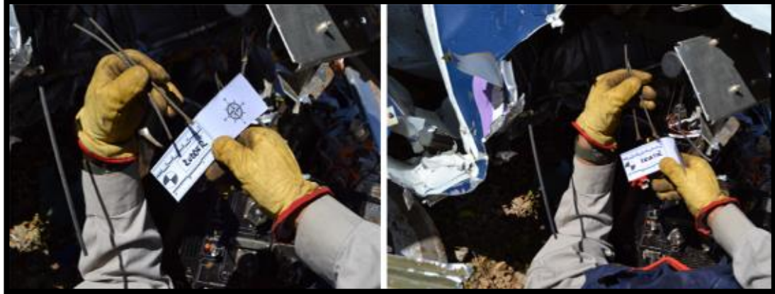
Fotografías N°15. Cables del elevador y el timón de dirección, cortados.
