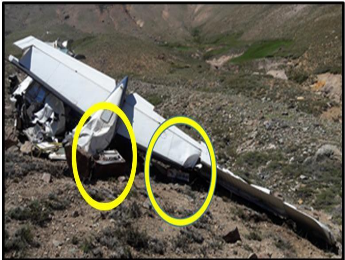
Fotografía N°12. Ubicación de equipos de aerofotogrametría aérea.
