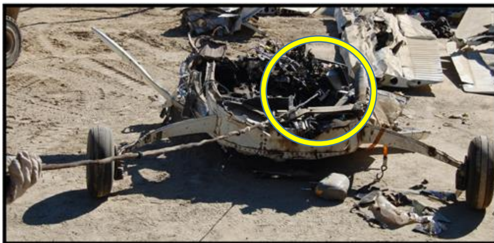
Fotografía N°21. Sistema de alimentación eléctrica para la cámara aerotransportada marca Leica ALS60.
