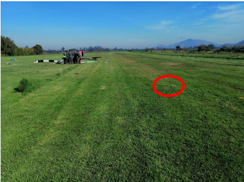
Fotografía N° 6: Vista de la huella del enganche del patín izquierdo (círculo rojo), con el terreno.
