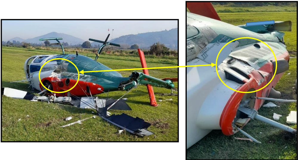
Fotografías N° 13 y 14: Daño a la capota superior.
