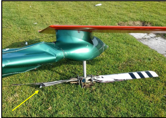
Fotografía N° 18: Vista del rotor de cola y una pala destruida.
