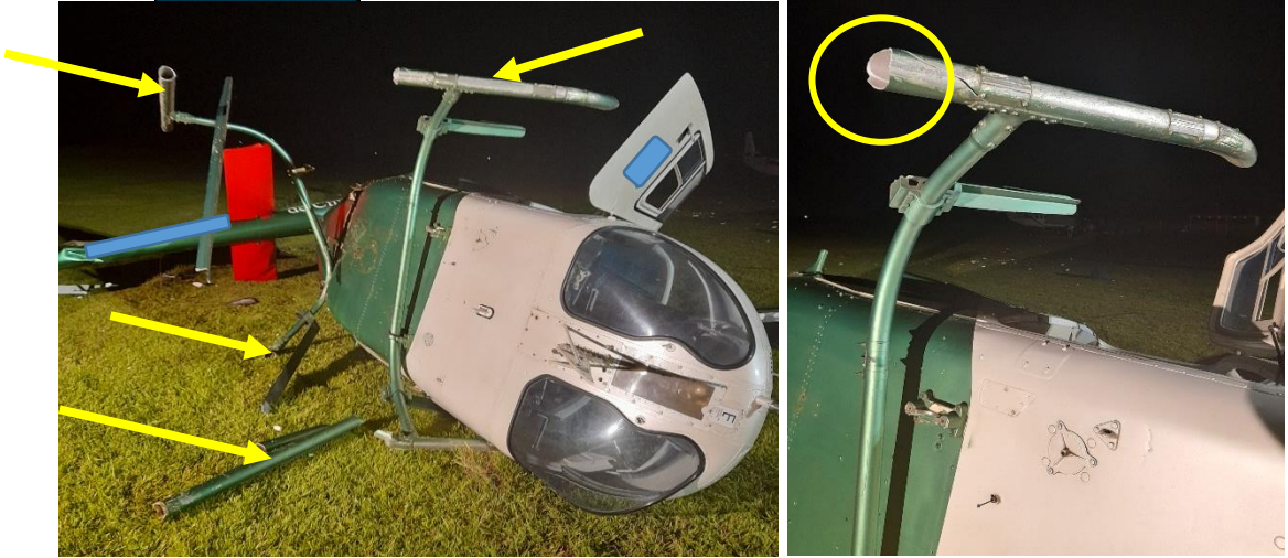
Fotografías N° 21 y 22: Vistas de los daños en el tren de aterrizaje.
