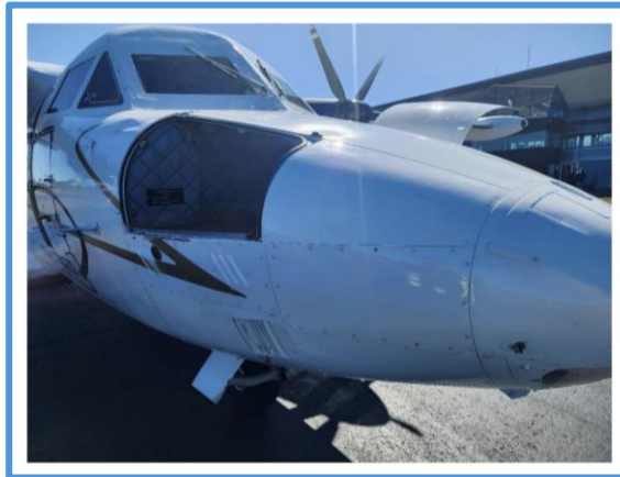
Fotografía N° 1: Aeronave aterrizada sin puerta delantera de bodega derecha.
