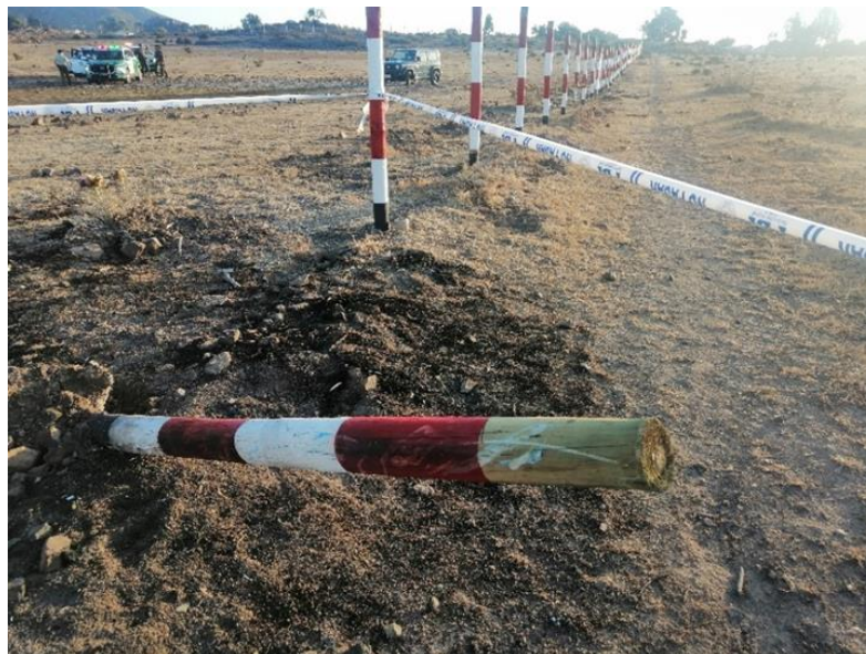
Fotografía N° 6: Vista de las huellas del impacto de la aeronave contra el pilote.
