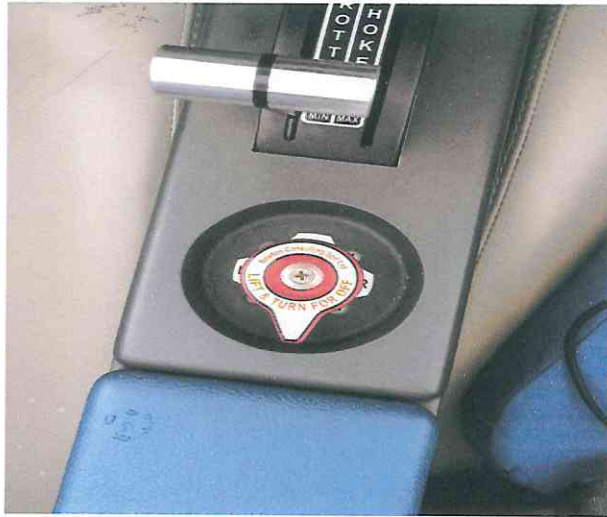
Fotografía N°3: Referencial Válvula de combustible
