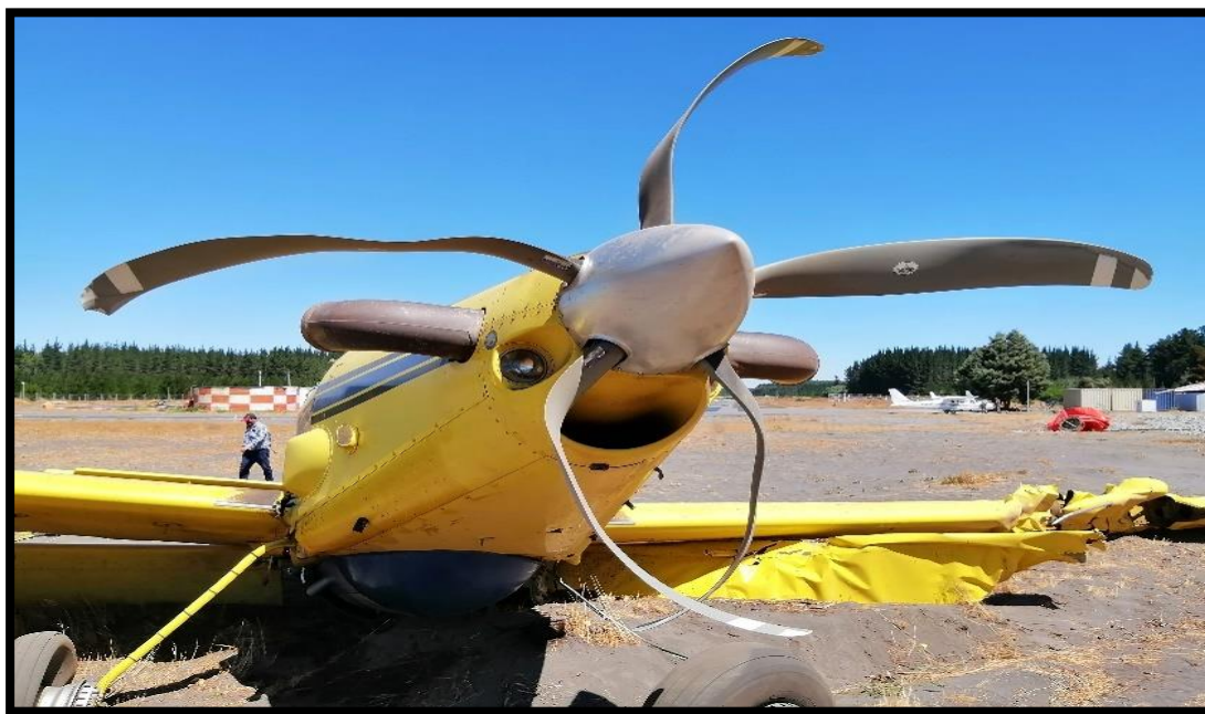
Fotografía N°11: Palas de la hélice.
