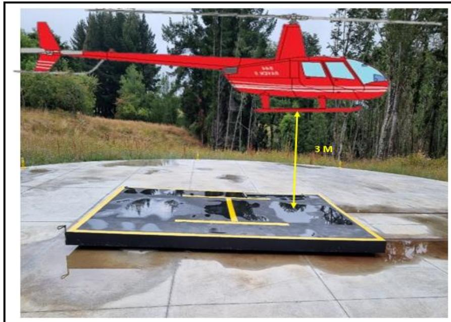
Fotografía 10: Vuelo estacionario del helicóptero (recreación).
