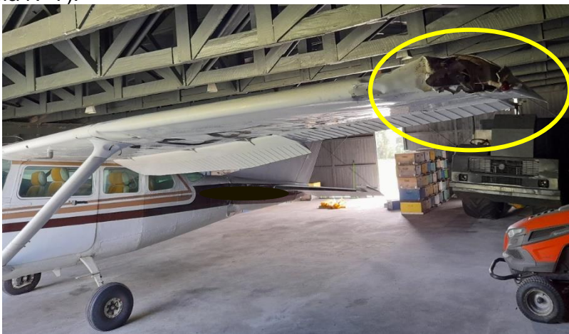
Fotografía N° 7: Vista del daño del ala izquierda.
