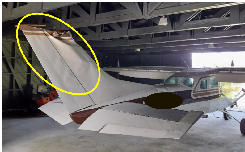
Fotografía N° 5 y 6: Vista de los daños en el fuselaje.
