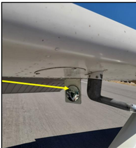
Imagen N°7: Espejo verificador de posición de tren de aterrizaje
