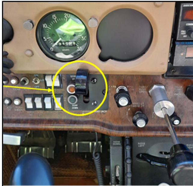
Imagen N°6: Palanca accionadora de tren de aterrizaje
