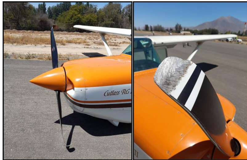
Imágenes N°4 y 5: Daños en la hélice de la aeronave
