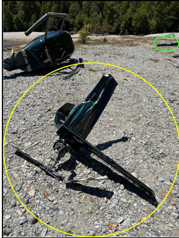
Fotografía N° 3: Vista posterior de la aeronave y de la ubicación final del rotor de cola (círculo amarillo) y cono de cola (círculo verde).
