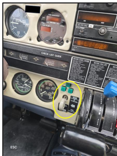
Imagen N°5: Palanca accionadora del tren de aterrizaje
