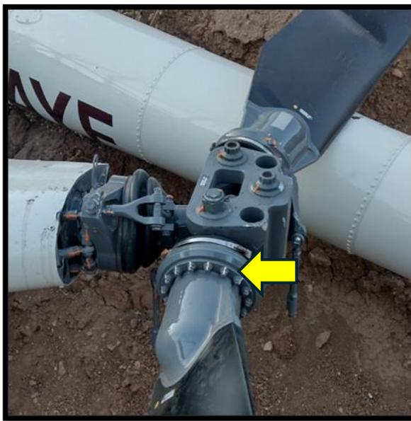
**Imagen 9:** Varillas de cambio paso de palas rotor principal, fracturas.
