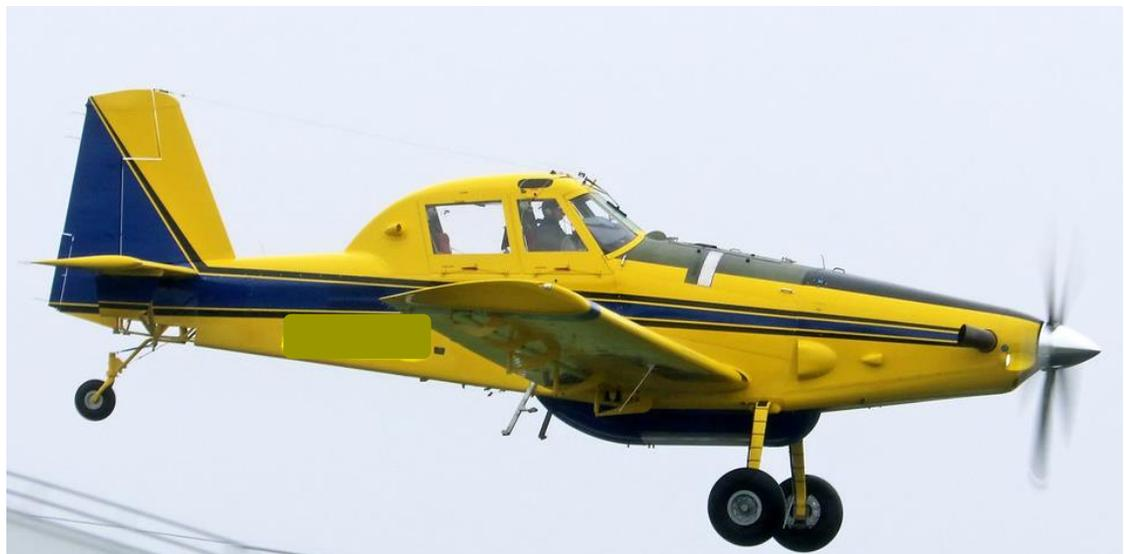
Fotografía referencial: Air Tractor modelo AT-802A.
