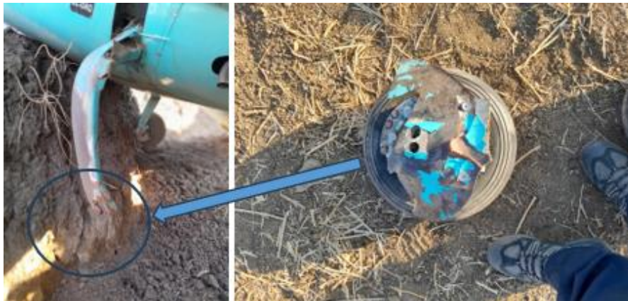
Fotografía N°4: Tren de aterrizaje principal izquierdo fracturado.
