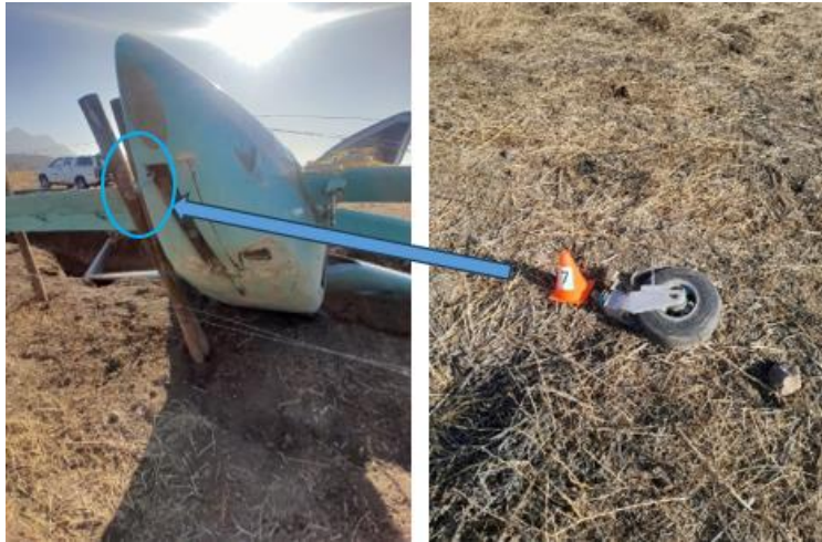
Fotografía N°3: Tren de aterrizaje delantero fracturado.
