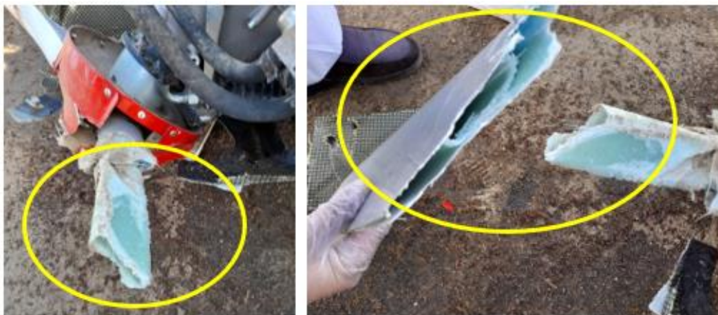
Fotografía N°7 y 8: Hélice Marca FITI Mod.3 LR. 158 fracturadas.
