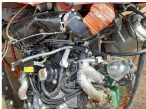
Fotografía N°5 y 6: Motor ROTAX Mod. 912 ULS2-01.
