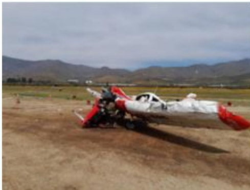
Fotografía N°3 y 4: Daños en Alas y Fuselaje aeronave BRISTELL S-LSA.
