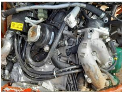
Fotografía N°5 y 6: Motor ROTAX Mod. 912 ULS2-01.
