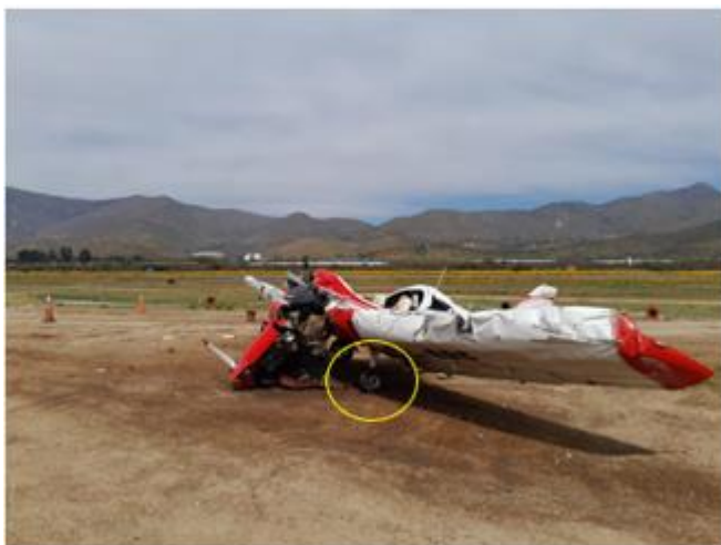
Fotografía N°9 y 10: Tren de aterrizaje con deformación y torción de las piernas
