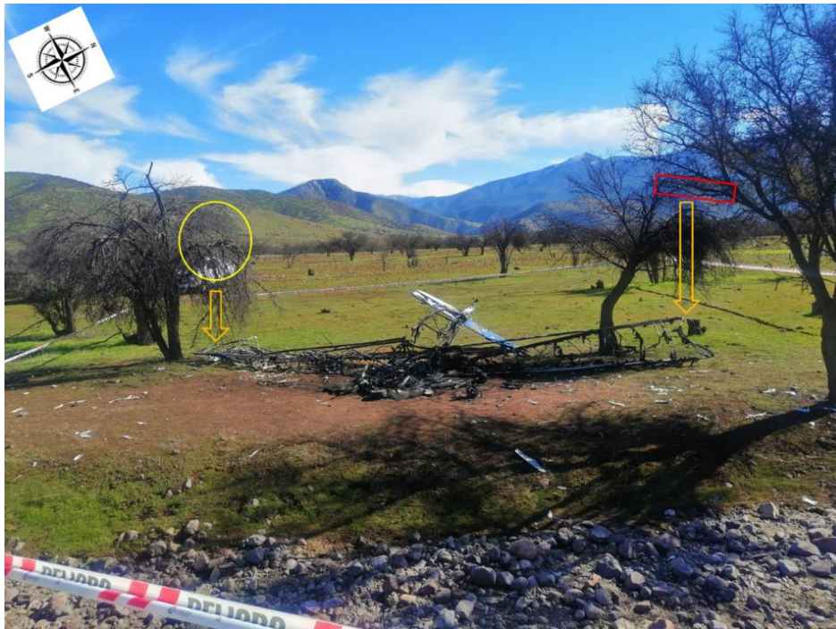
Fotografía N°4: Vista, al rumbo 320^\circ , de la ubicación final de la aeronave, con evidencia de impactos de los costados de las alas del ULM (flechas amarillas) en las ramas de los arbustos laterales (círculo amarillo y rectángulo rojo).
