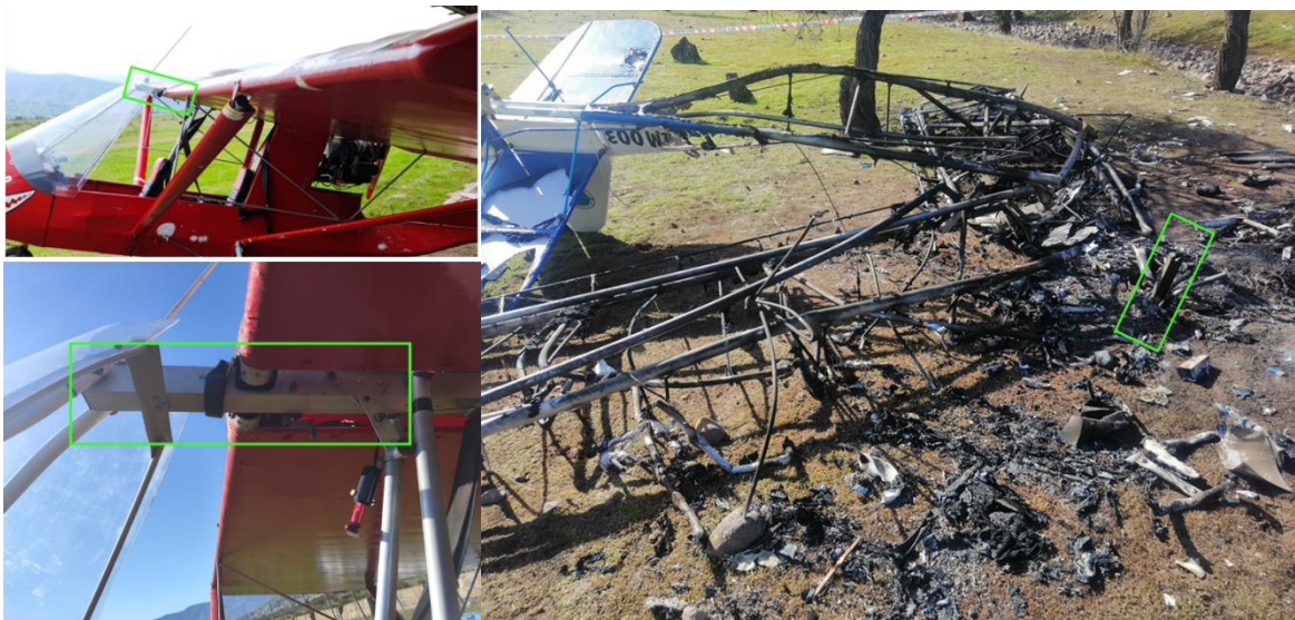
Fotografías N°6, 7 y 8: Vista que, compara la estructura superior delantera del ULM, con la que se encontró enterrada en el terreno (cuadros verdes).
