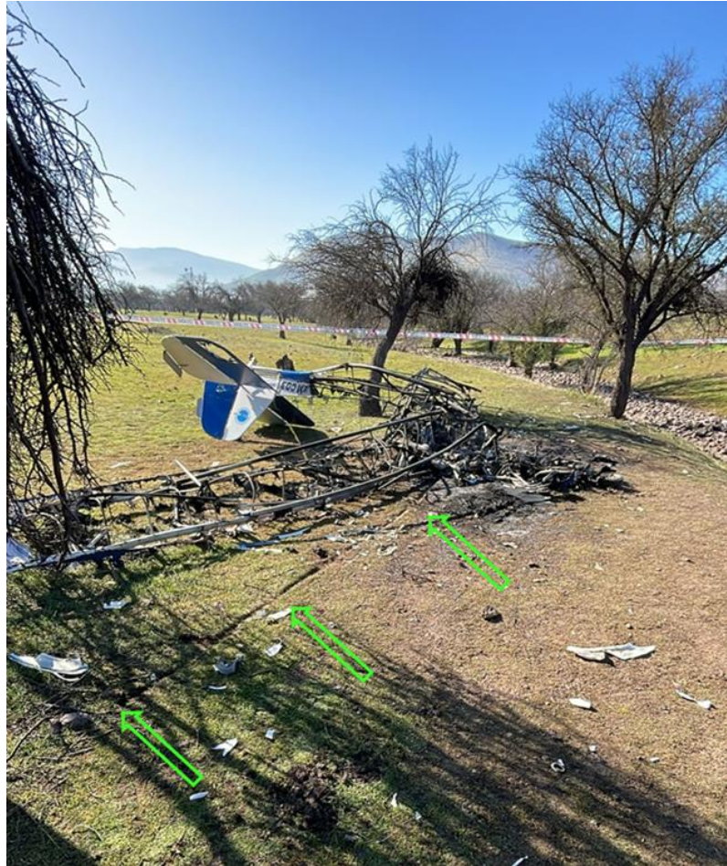
Fotografía N°5: Vista lateral del ULM, con huella del impacto del borde de ataque de las alas contra el terreno (flechas verdes), no evidenciando huellas de arrastre.
