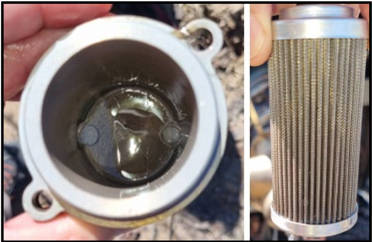
Fotografías N°14 y 15: Filtro de combustible.
