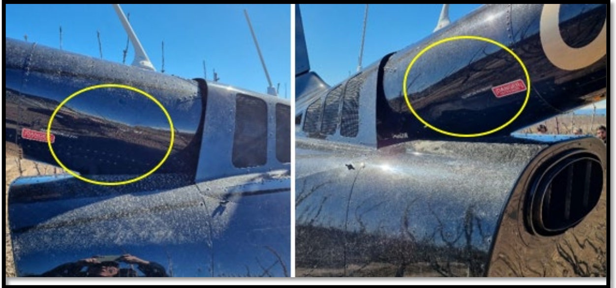
Fotografías N° 6 y N°7: Deformaciones en cono de cola.
