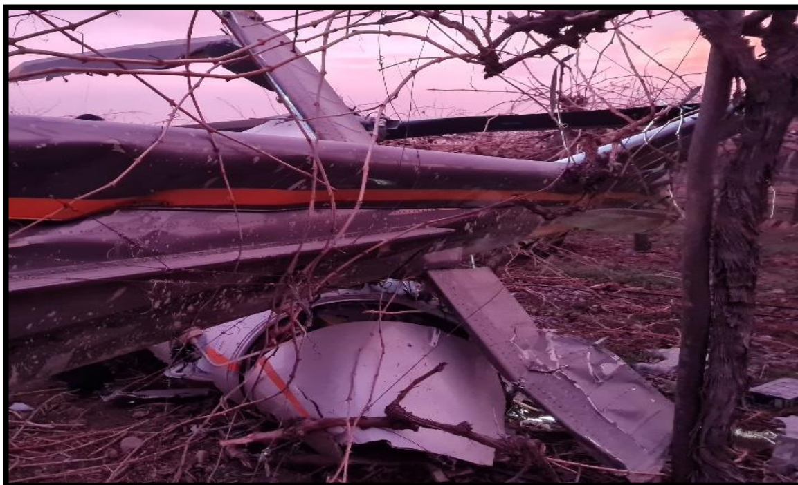
Fotografía N°2: Vista del cono de cola y del estabilizador horizontal.
