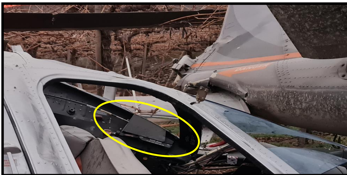
Fotografía N°1A: Estructura central de separación entre los parabrisas.
