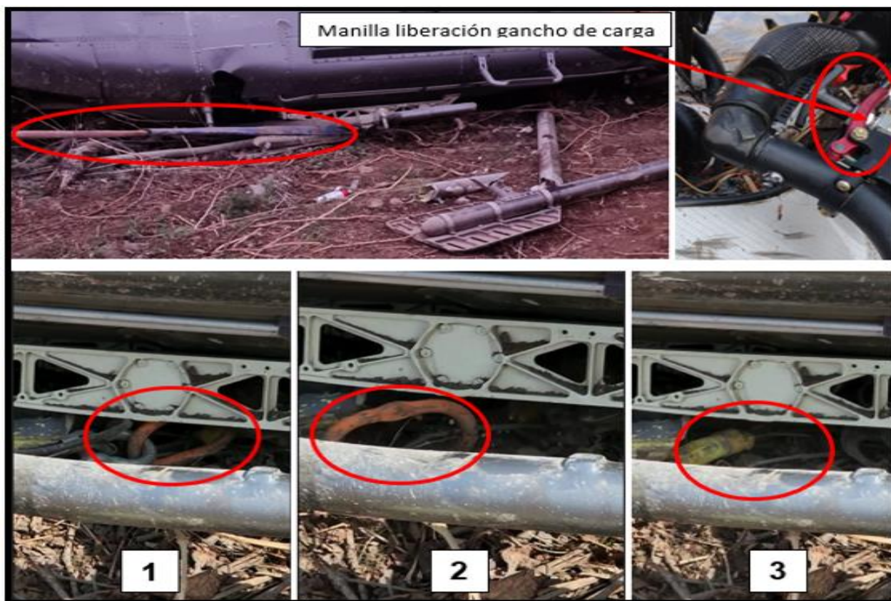
Fotografía N°9: Desconexión gancho de carga.
