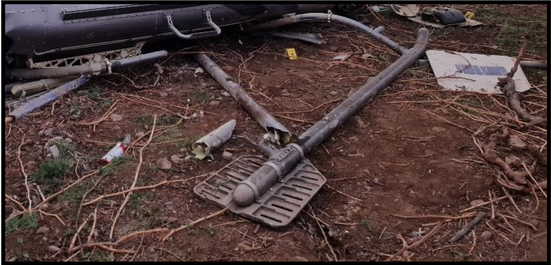
Fotografía N°3: Vista de los tubos deslizantes y cruzados.
