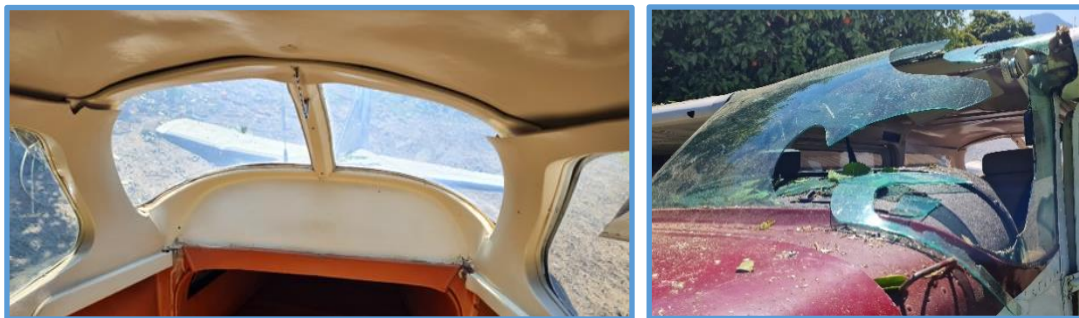
Fotografías N° 21 y 22: Ventanilla con fracturas y Parabrisas delantero.
