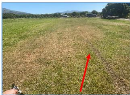
Fotografías N° 3 y 4: Marcas visibles de frenado fuera de límites de pista (rumbo 280°).
