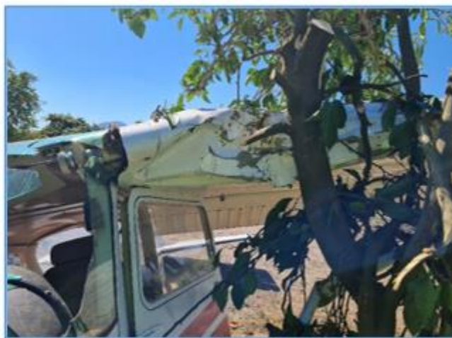
Fotografías N° 17 y 18: Deformaciones en ala izquierda y soporte.
