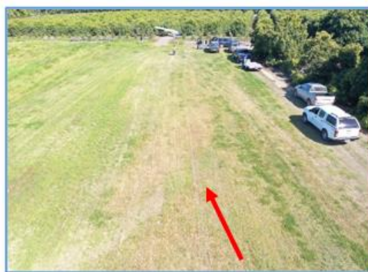
Fotografías N° 3 y 4: Marcas visibles de frenado fuera de límites de pista (rumbo 280°).
