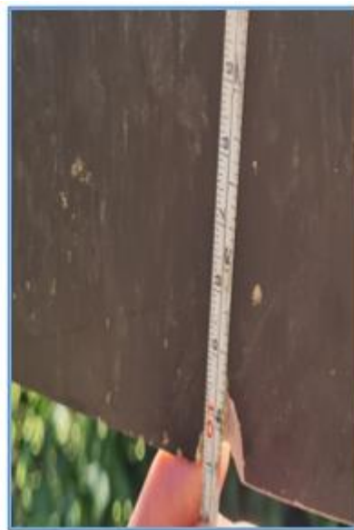
Fotografías N° 7 y 8: Muesca en borde de ataque de la hélice.
