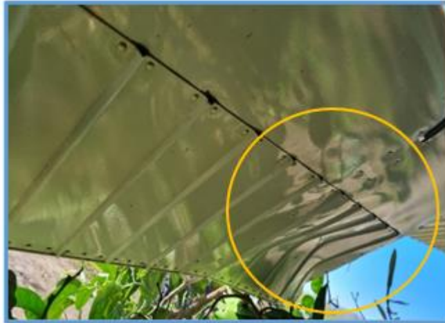
Fotografía N° 19: Flaps izquierdo con deformación.
