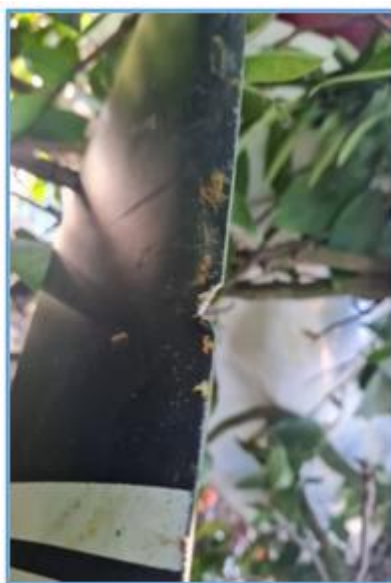
Fotografías N° 7 y 8: Muesca en borde de ataque de la hélice.
