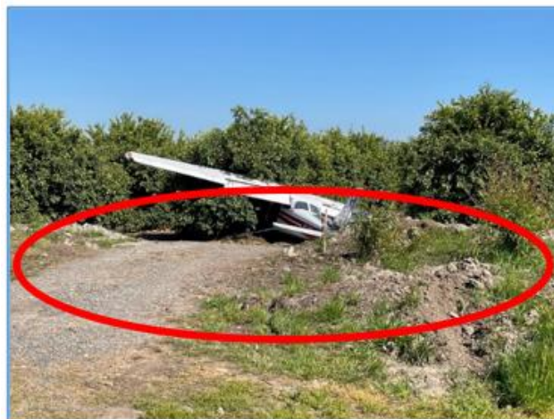
Fotografía N° 2: Montículo de tierra al borde de la acequia traspasada por la aeronave antes del impacto final.
