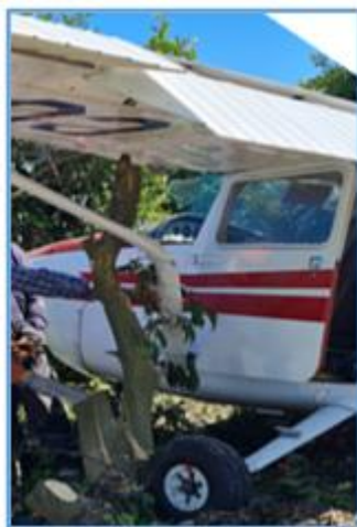
Fotografías N° 17 y 18: Deformaciones en ala izquierda y soporte.
