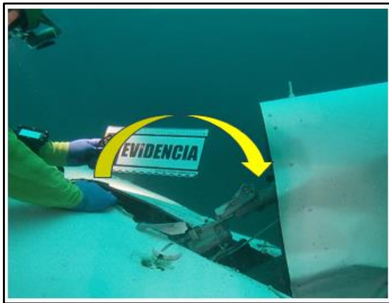
Fotografía N°10: Desplazamiento hacia atrás de transmisión y rotor principales.
