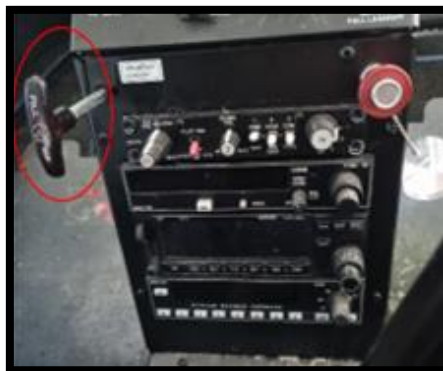
Imagen N°10 y fotografía N°26: Sistema de ventilación de cabina R 44 II.
