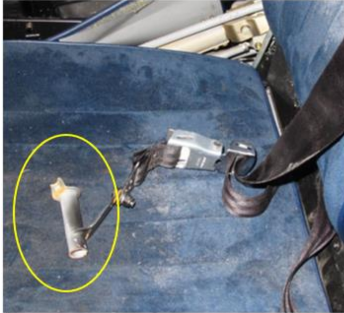
Fotografía N°17. Anclaje de cinturón de seguridad trasero del lado izquierdo, fracturado.
