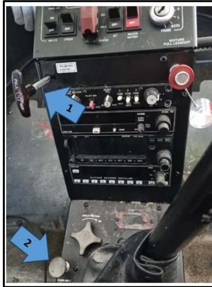
Fotografía N°12. Ubicación de los controles de ingreso de aire frontal o de impacto y de aire caliente a la cabina.
