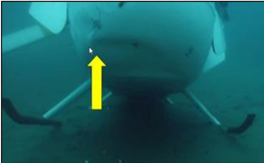
Fotografía N°2. Daños en costado derecho del fuselaje (vista frontal).
