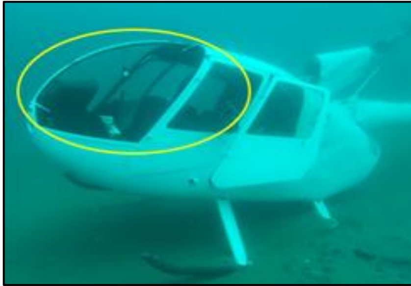
Fotografías N°3: Parabrisas izquierdo, desprendido.
