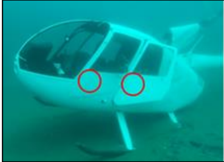
Fotografía N°6. Ventilaciones de las puertas de acceso a la cabina cerradas.
