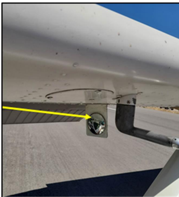
Imagen N°8: Espejo verificador de posición de tren de aterrizaje
