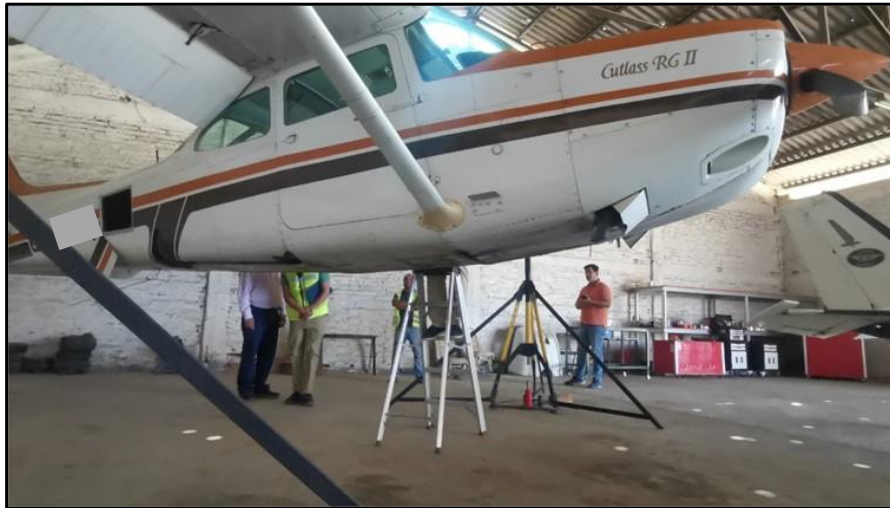
Imagen N°11: Aeronave con el tren de aterrizaje replegado (arriba).
