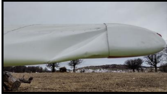
Imagen N°10: Daños en la punta del ala izquierda.
