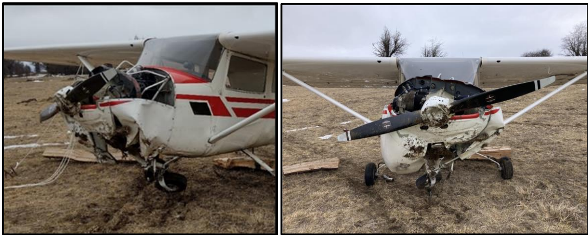
Imágenes N°8 y 9: Daños en la parte delantera de la aeronave.
