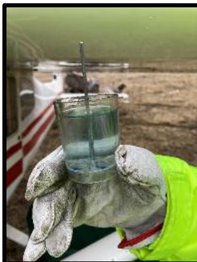
Imagen N°2: Muestra de combustible
