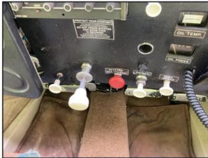
Imagen N°12: Controles de mandos del motor
