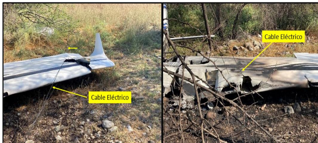
Imágenes N°7 y 8: Cables eléctricos en contacto con ala izquierda.
