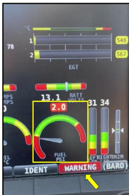
Imagen N°25: Panel de indicación parámetro de presión de combustible.
