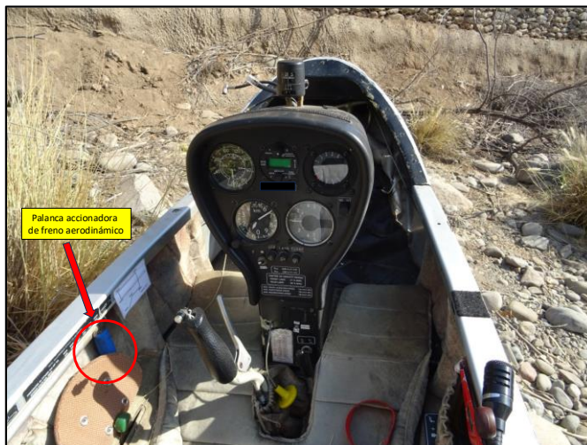
Imágenes N°13: Palanca accionadora del freno aerodinámico en cabina.
