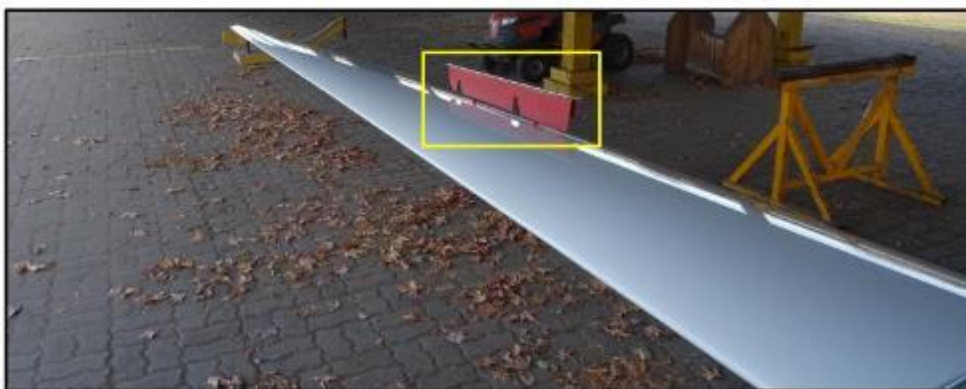
Imagen N°14: Referencia del freno aerodinámico desplegado.
