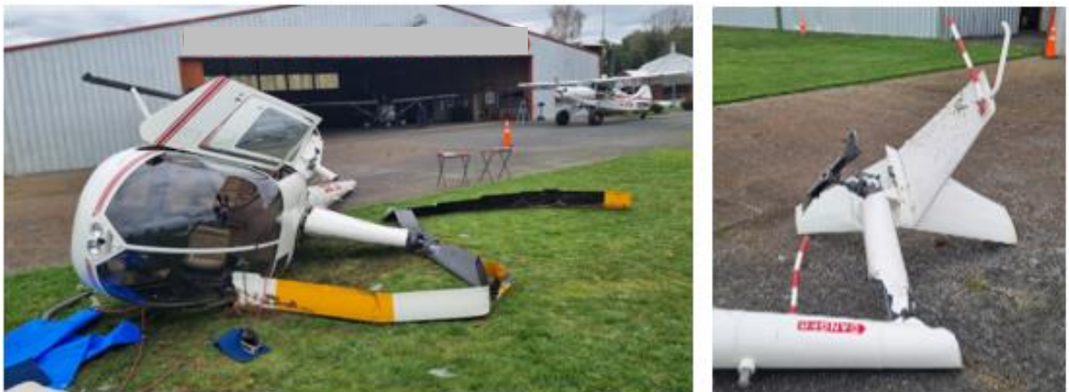
Fotografía N°4 y 5: Deformaciones y fracturas en conjunto de palas del rotor principal, cono de cola y rotor de cola.
