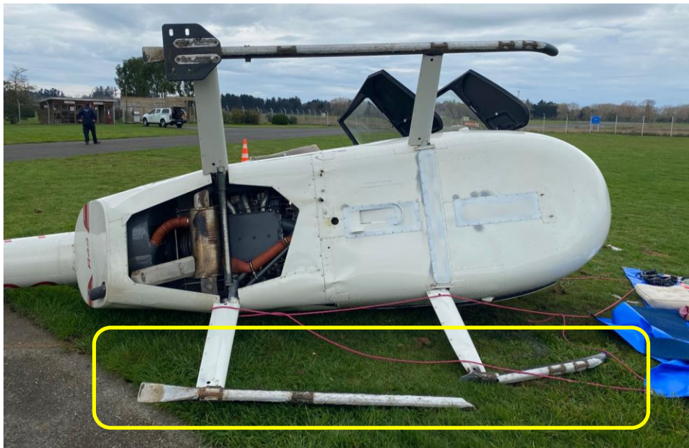
Fotografías N°8: Fractura tren de aterrizaje tipo SKID.
