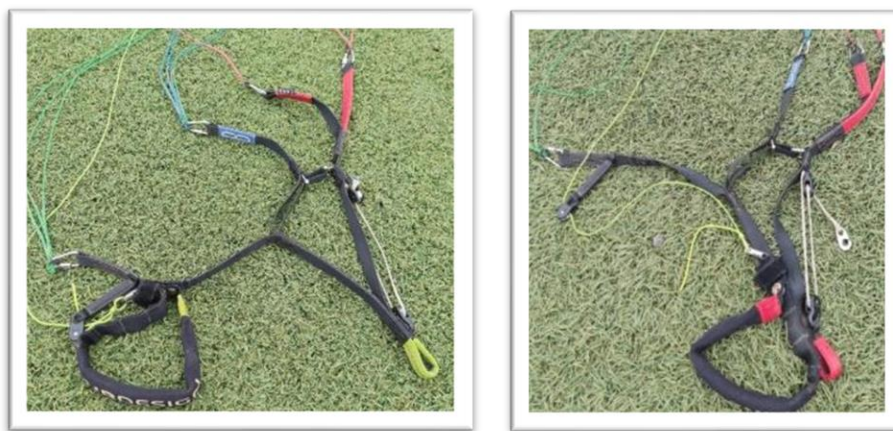
Fotografía 6 y 7: Los mandos del parapente y los sistemas de control.
