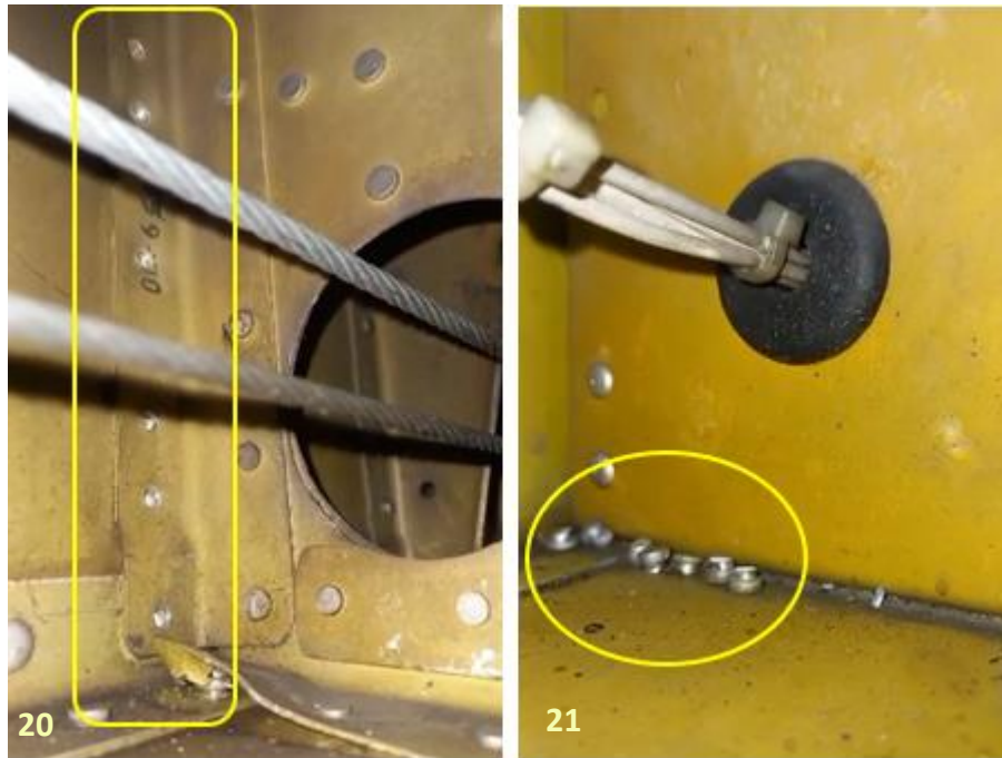
Fotografías N°20 y 21: Vista del daño en el ala izquierda y cabezas de remaches cortadas de la aeronave.
