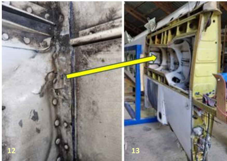
Fotografías N°12 y 13: Daños en el alojamiento de la rueda izquierda y del tren de aterrizaje principal izquierdo.
