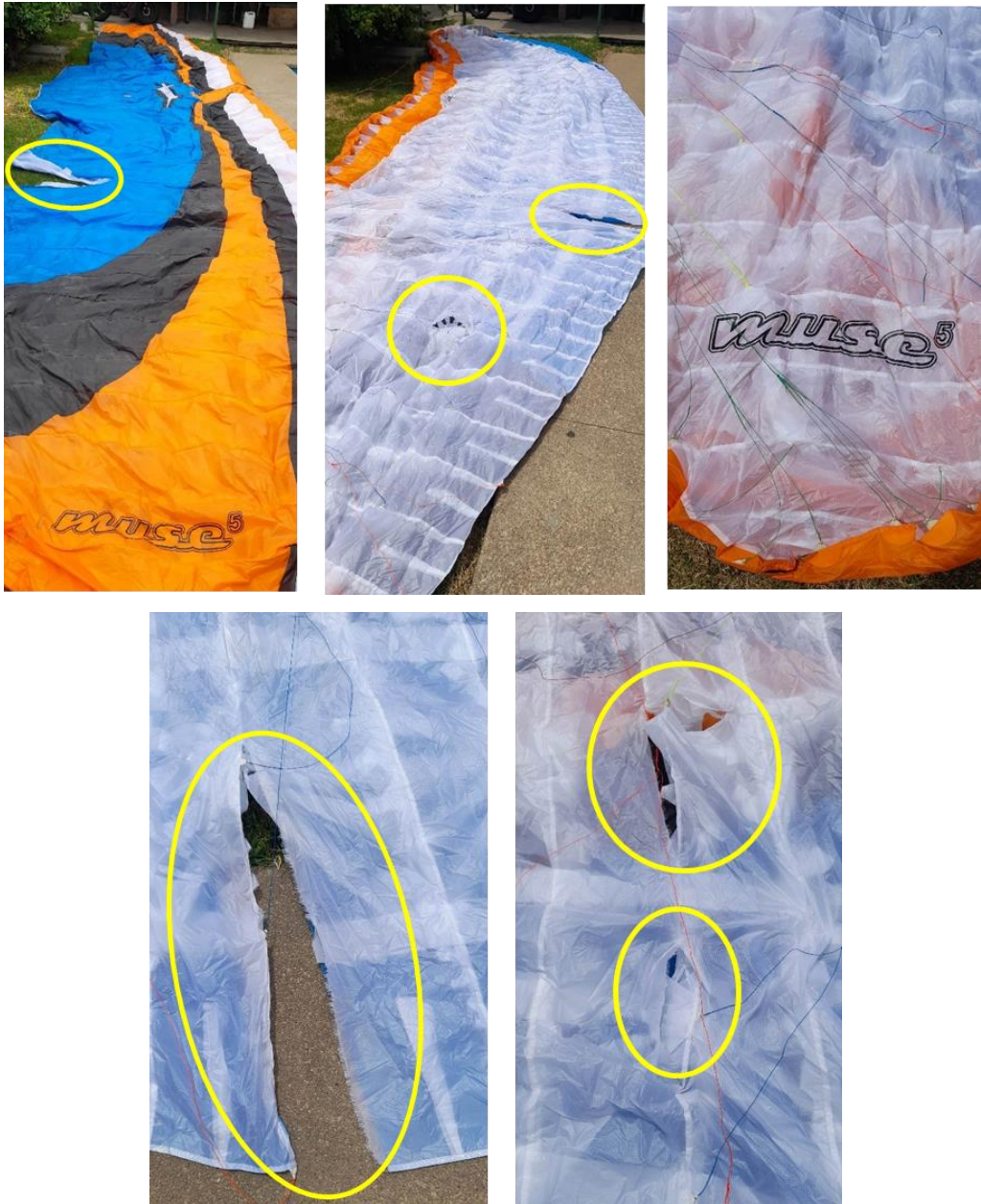
Fotografías N° 5 a 9: Vista de los daños, en la parte superior e inferior, de la vela.
